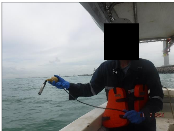
รูปที่ 2-30 อุปกรณ์ตรวจวัดความเป็นกรดและด่าง และอุณหภูมิแบบต่อเนื่อง บริเวณปลายของคลองระบายน้ำหล่อเย็นของโครงการฯ
