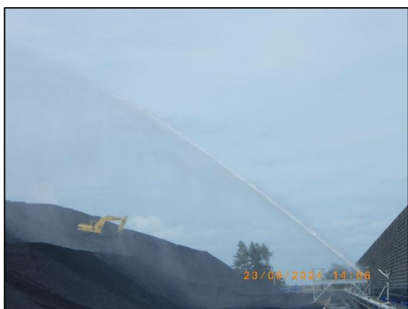
รูปที่ 2-4 การฉีดสเปรย์น้ำบริเวณลานกองถ่านหิน ของโครงการฯ
