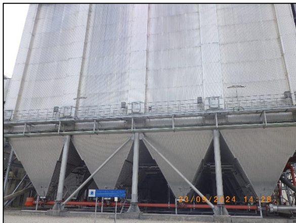
รูปที่ 2-6 ระบบดักจับฝุ่นละอองโดยใช้ไฟฟ้าสถิตย์ (EP)
