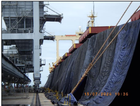
รูปที่ 2-32 การติดตั้งผ้าใบขณะมีกิจกรรม การขนถ่ายถ่านหิน
